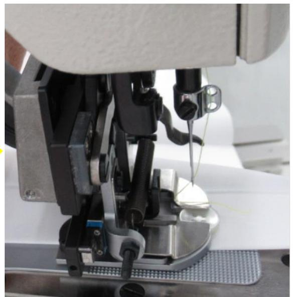
**2. 押え圧力が強く、縫製中の生地ズレによる縫い不良を解消！**
